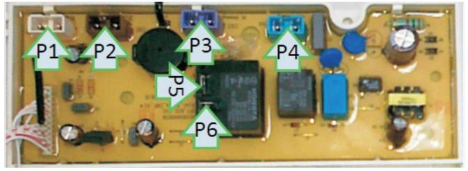
P1 : Sonde de température // P2 : Interrupteur de porte // P3 : Moteur
