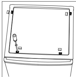
2. Schroef het bovenste scharnier los. Verwijder vervolgens de bovenste deur en plaats ze op een zacht oppervlak om krassen te vermijden.
