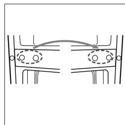
6. Schroef het onderste scharnier los. Verwijder vervolgens de verstelbare voetjes aan beide zijden.
