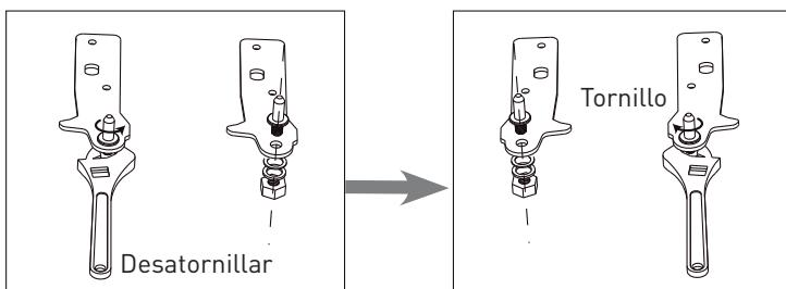
8. Vuelva a colocar el soporte colocando el pasador de la bisagra inferior. Vuelva a colocar ambas patas ajustables. Transfiera la puerta inferior a la posición pertinente.
