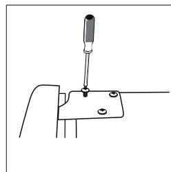
12. Coloque la tapa superior y vuelva a apretar los tornillos.
