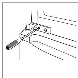
11. Plaats de bovenste deur opnieuw. Zorg ervoor dat de deur horizontaal en verticaal afgelijnd is zodat de dichtingen aan alle zijden gesloten zijn alvorens het bovenste scharnier vast te draaien. Plaats het scharnier en schroef ze vast op de bovenkant van de eenheid.
