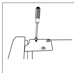
12. Plaats het bovenste deksel op nieuw op zijn plaats en schroef ze vast.
