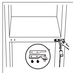
5. Verplaats de deksels van de schroegaten van de linkerzijde naar de rechterzijde.
