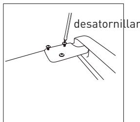
3. Retire el pasador con un destornillador y voltee el soporte de la bisagra. Seguidamente, vuelva a colocar el pasador en el soporte de la bisagra.
