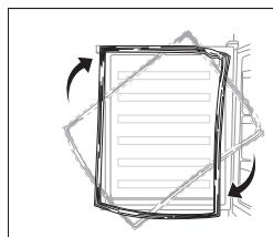
10. Inversez le sens de la charnière centrale de 180 °C, puis positionnez-la correctement sur la gauche. Placez l'axe de la charnière centrale dans le trou supérieur de la porte inférieure, puis serrez les vis.
