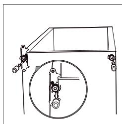
9. Retire las juntas de la puerta del frigorífico y del congelador y luego fíjelas después de girarlas.
