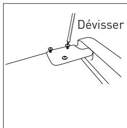
3. Retirez l'axe à l'aide d'un tournevis et retournez le support de charnière. Ensuite, réinstallez l'axe sur le support de charnière.
