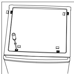
2. Desatornille la bisagra superior y luego retire la puerta superior y colóquela sobre una manta suave para evitar los arañazos.
