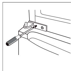
11. Coloque la puerta superior de nuevo en su lugar. Asegúrese de que la puerta esté alineada horizontal y verticalmente, de modo que las juntas estén cerradas en todos los lados antes de apretar la bisagra superior. Seguidamente, inserte la bisagra y atorníllela a la parte superior de la unidad.
