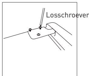
3. Verwijder de pin met een schroevendraaier en kantel het haakje van het scharnier. Plaats daarna de pin opnieuw op het haakje van het scharnier
