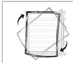
10. Draai de richting van het middelste scharnier  $180^\circ$  om en verplaats ze naar de linker positie. Plaats de pin van het middelste scharnier in het gat bovenaan en draai de bouten vast.
