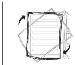
10. Invierta la dirección de la bisagra central 180 °C y, seguidamente, transfírala a la posición pertinente en el lado izquierdo. Inserte el pasador de la bisagra central en el orificio superior de la puerta inferior y apriete los pernos.
