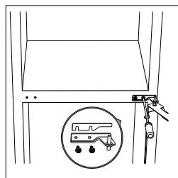
5. Mueva las tapas de los orificios de las bisagras de la parte izquierda a la parte derecha.
