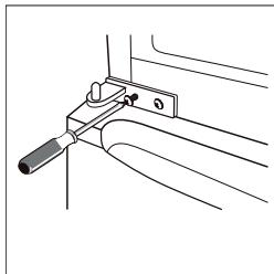
11. Remettez en place la porte supérieure. Assurez-vous d'aligner la porte horizontalement et verticalement, de façon à ce que les joints ferment de manière hermétique de tous les côtés, avant de resserrer la charnière supérieure. Insérez ensuite la charnière et vissez-la sur le dessus de l'appareil.
