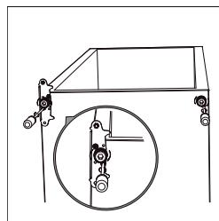
9. Démontez les joints des portes du réfrigérateur et du congélateur, puis réinstallez-les après avoir procédé à l'inversion.
