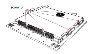
Step2: remove the screw B
