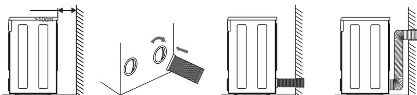
Connecter le tube flexible à l'ouverture d'évacuation d'air située à l'arrière de l'appareil puis fixez-le bien. L'autre extrémité du tube doit être placée à l'extérieur comme montré sur le schéma ci-dessus.
