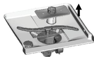
Etape 2 : Soulevez l'assemblage du système du filtre.
