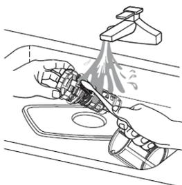
Des restes d'aliments plus grands peuvent être nettoyés en rinçant le filtre sous l'eau du robinet. Pour un nettoyage plus en profondeur, utilisez une brosse de nettoyage douce.
