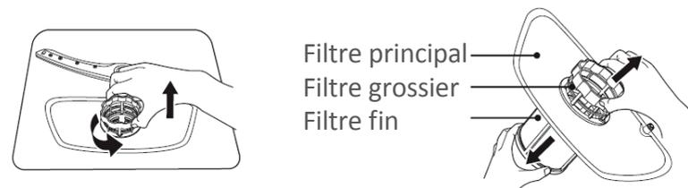
Tenez le filtre grossier et faites-le tourner dans le sens inverse des aiguilles d'une montre pour déverrouiller le filtre. Soulevez le filtre et retirez-le du lave-vaisselle.
