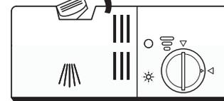
1. Appuyez sur le loquet de dégagement sur le distributeur de détergent pour ouvrir le couvercle.
