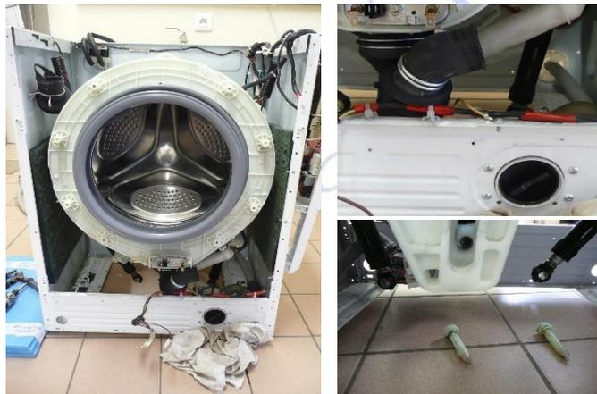
Retirer les axes des amortisseurs et démonter la durite au niveau de la pompe de vidange.
