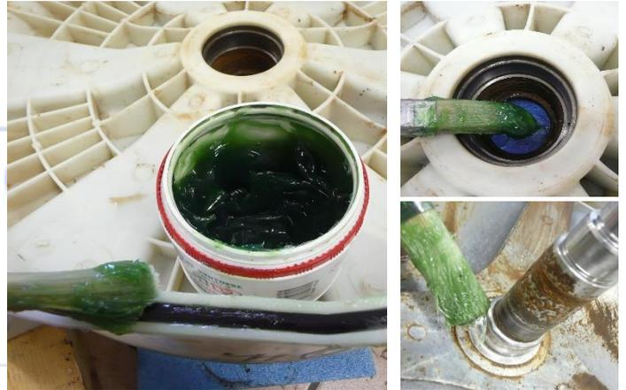
Dégraisser le joint de cuve, le logement de roulement et le croisillon. **Attention: utiliser une graisse résistante à l'eau et aux hautes pressions.**
