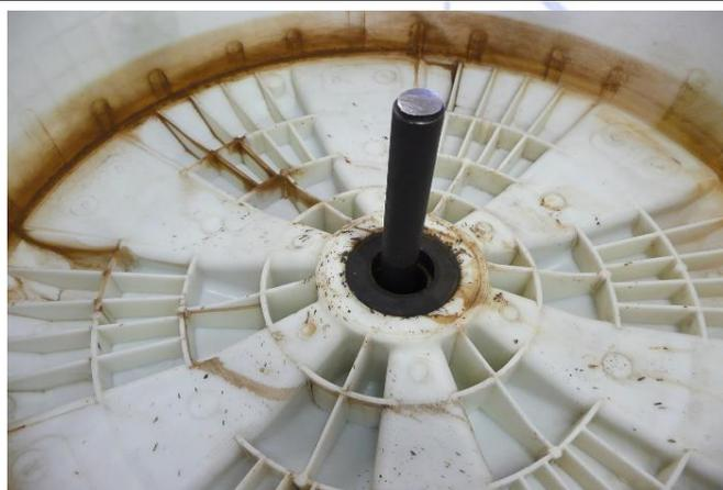
Retirer le roulement extérieur à l'aide du chasse roulement. Positionner la demi-cuve sur 2 tasseaux de bois afin de ne pas l'endommager.
