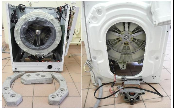
Retirer le dessus et la façade du lave linge puis démonter les contre-poids supérieurs et avant, décrocher le moteur.
