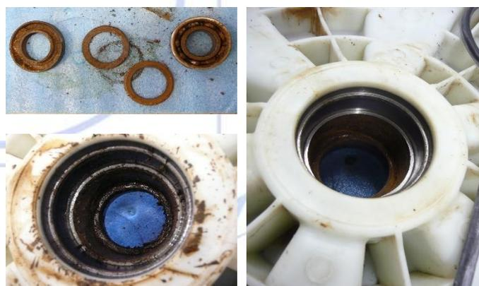
Lorsque les roulements ont été extraits, nettoyer le logement à l'aide d'un chiffon et d'un nettoyant. Exemple de produit: alcool ménager, essence F
