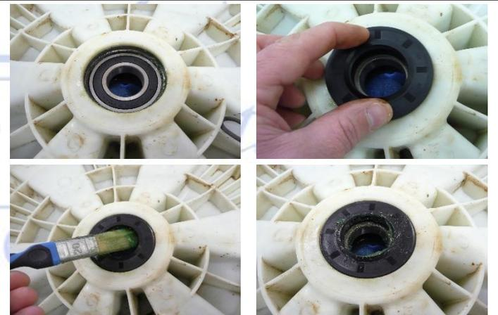
Remplacer le joint spi, positionnement à la main et graisser. **Ne jamais frapper sur le joint spi.**
