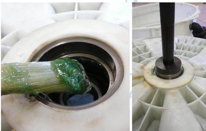
Positionner le roulement extérieur, frapper pour l'enfoncer en butée du moyeu: lors de la frappe le bruit "sourd" devient "métallique".
