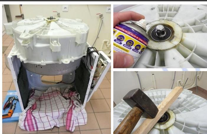
Mettre du dégrissant au niveau du croisillon et laisser agir quelques minutes. Placer le tasseur sur la vis de poulie, frapper à l'aide du marteau pour sortir le tambour.
