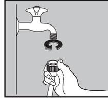
**En présence d'une valve d'alimentation à l'arrière de l'appareil, elle doit être raccordée à l'alimentation en eau froide. Si deux valves d'alimentation sont présentes, l'une sert au raccordement à l'alimentation en eau froide et l'autre sert au raccordement à l'alimentation en eau chaude. Respectez les indications de l'illustration ci-dessous pour effectuer le raccordement.**
