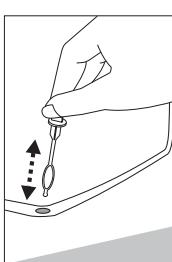
► NETTOYEZ REGULIEREMENT LE DRAIN D'ÉCOULEMENT DE L'EAU DU DEGIVRAGE AVEC LE NETTOYANT **4** PREVU A CET EFFET (Fig. 1).
