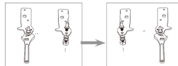
8. Réinstallez le gond de charnière inférieure sur le support. Réinstallez les deux pieds réglables. Transférez la porte inférieure dans la position appropriée.
