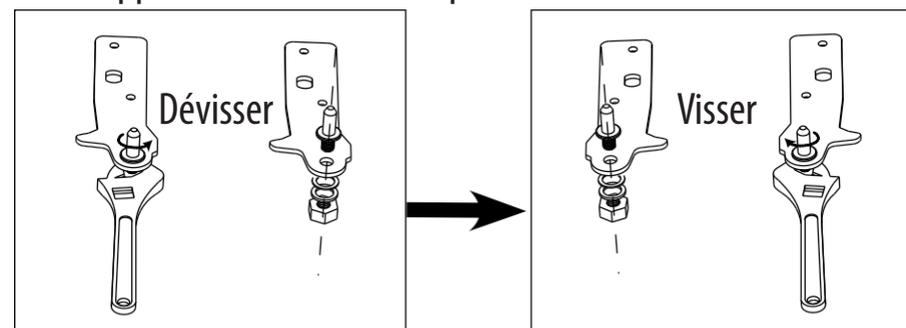
8. Réinstallez le support de fixation du gond de la charnière du bas. Remettez en place les deux pieds ajustables. Mettez la porte du bas dans la position correspondante.
