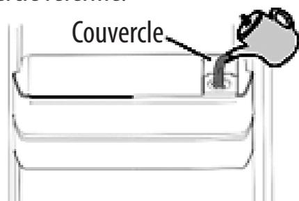
**ATTENTION !** Fixez soigneusement le réservoir sur la porte du réfrigérateur. Le réservoir risque de ne pas fonctionner correctement s'il est mal fixé. N'essayez pas d'utiliser le réfrigérateur sans le réservoir. Il risquerait de ne pas fonctionner au mieux de ses capacités.
