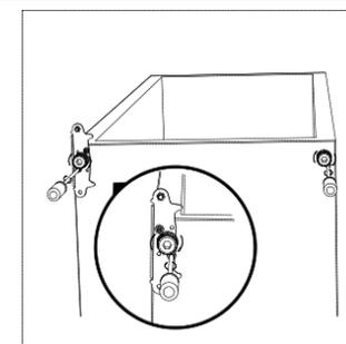
9. Retournez la charnière du milieu à 180°C et transférez-la sur la position de gauche. Mettez le gond de la charnière du milieu dans le trou supérieur de la porte du bas, puis serrez les boulons.
