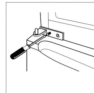
10. Remettez en place la porte du haut. Avant de fixer définitivement la charnière du haut, assurez-vous que la porte est parfaitement bien alignée, aussi bien horizontalement que verticalement, afin de garantir une fermeture hermétique de l'appareil. Puis insérez la charnière et vissez-la en haut de l'appareil.
