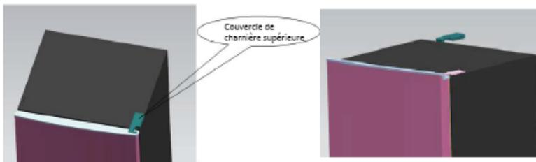
2. Retirer les vis fixées à la charnière supérieure avec le tournevis cruciforme.
