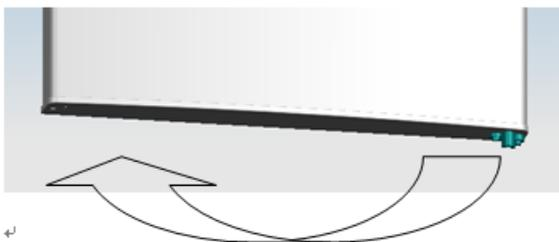
B. Remplacer le pied réglable et placer-le sur le côté opposé.
