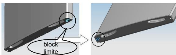
4. Démontez les vis fixées à la charnière inférieure avec le tournevis cruciforme.
