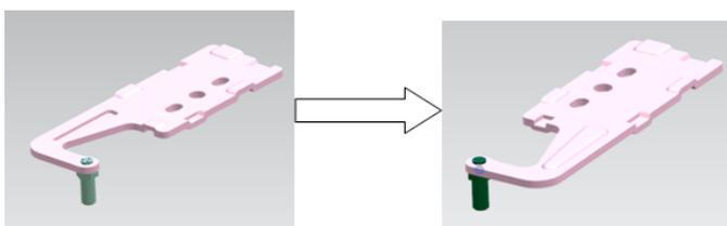
B. Décoller la porte supérieure puis retirer le bloc de limite de porte et placer-le sur le côté opposé.
