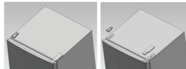
2. Retirer les vis fixées à la charnière supérieure avec le tournevis cruciforme.
