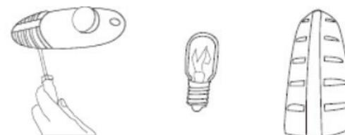
3. Remplacez-la par une ampoule de 15 watts MAX et de type E14.
