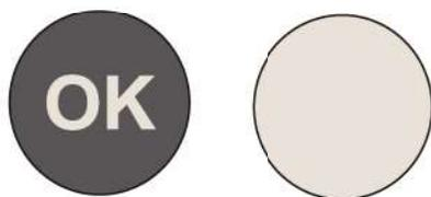
Si «OK» n'apparaisse pas, la température de la zone est trop élevée. Réglez le thermostat sur une position supérieure. Attendez au moins 12 heures avant de réajuster le thermostat. Après le chargement des denrées fraîches dans l'appareil ou après les ouvertures répétées (ou ouverture prolongée) de la porte, il est normal que l'inscription «OK» n'apparaisse pas dans l'indicateur de température.
