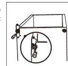
11. Installer la porte. Assurez-vous que la porte est alignée horizontalement et verticalement afin que le joint soit fermé de tous les côtés avant de serrer finalement la charnière supérieure.
