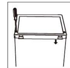
13. Détacher les joints des portes du réfrigérateur puis fixez-les après inversion.
