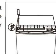
12. Mettez le couvercle supérieur et fixez-le avec 2 vis à l'arrière.
