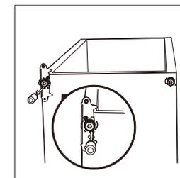
11. Installer la porte. Assurez-vous que la porte est alignée horizontalement et verticalement afin que le joint soit fermé de tous les côtés avant de serrer finalement la charnière supérieure.
