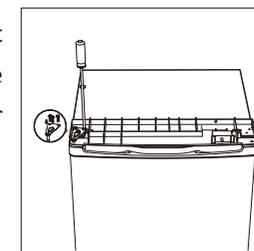
12. Mettez le couvercle supérieur et fixez-le avec 2 vis à l'arrière.
