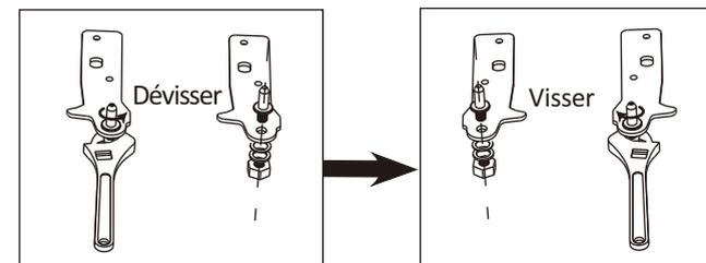
10. Remettez le support en place en le fixant à l'axe de la charnière inférieure. Remplacer les deux pied réglables.
