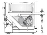
Laisser au minimum 2,5 cm d'espace entre le plateau de l'evaporateur et les aliments du bac 9, pour garantir le bon fonctionnement du congélateur.
