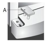
Enlever le carton inséré entre les deux portes et la cale plastique "A" se trouvant sur le support du bas.
