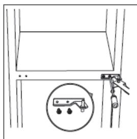
5. Placez le cache trou de la porte du bas au côté opposé. Soulevez ensuite la porte avant de la placer sur une surface souple pour éviter les rayures.
