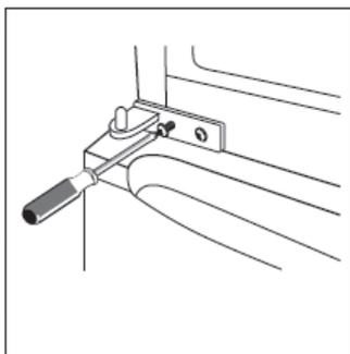
11. Reposez la porte du haut. Vérifiez que la porte soit correctement alignée horizontalement et verticalement afin que les joints soient bien en place de tous les côtés. Insérez la charnière
