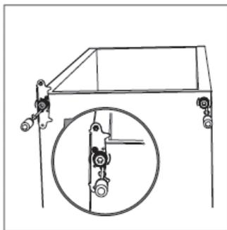
10. Retournez la charnière centrale de 180°, puis placez-la de façon à ce que l'ouverture se fasse à gauche. Faites entrer la tige de la charnière centrale dans le trou du haut de la porte, puis serrez la vis de fixation.
