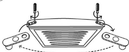
9. Placez la charnière du milieu sur la gauche du réfrigérateur et insérer le pistolet de charnière dans le trou de la porte, puis le fixer fermement.
