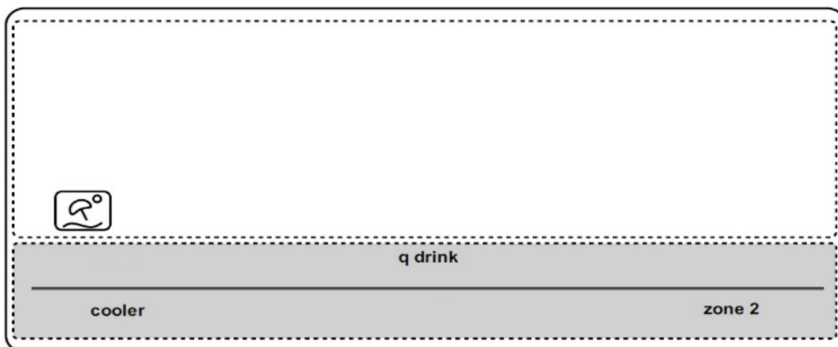
Pour sortir du test = Appui sur touche COOLER
