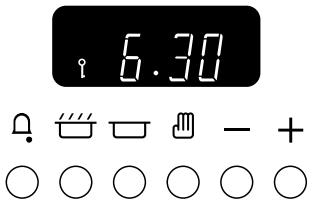
Die Öfen sind nun blockiert. Nach einigen Sekunden zeigt das Display wieder die Uhrzeit und das Schlüssel-Symbol.
