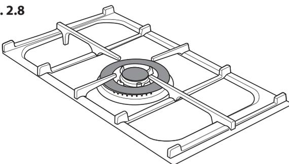
Le dispositif d'allumage produit une étincelle et allume le gaz. Continuez d'appuyer sur le bouton pendant quelques secondes pour permettre l'arrivée du gaz dans le brûleur.
