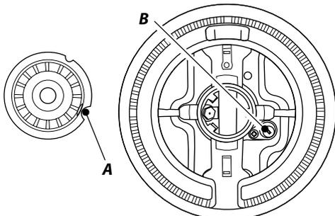
A – Encoche d'électrode, B – Electrode d'allumage
