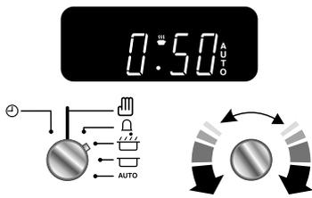
Tournez le bouton Minuterie pour le mettre sur la position [☰] (**Fig.2-26**). Utilisez le bouton Réglage pour régler le « temps de cuisson » comme indiqué ci-dessous (**Fig.2-27**).
