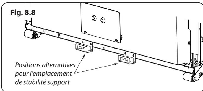
Si vous utilisez un support de stabilité; fixez d'abord le dispositif de localisation de support à l'arrière de la cuisinière (Fig. 8.8). Puis ajustez le support pour engager dans la fente de l'appareil (Fig. 8.9 et Fig. 8.10).
