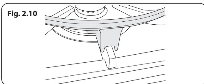
Le dispositif d'allumage produit une étincelle et allume le gaz. Continuez d'appuyer sur le bouton pendant quelques secondes pour permettre l'arrivée du gaz dans le brûleur (10 secondes).
