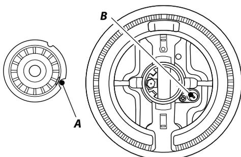
A – Encoche d'électrode, B – Electrode d'allumage
