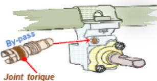
Les BY PASS ou VIS DE RALENTI équipent chaque robinet et sont calibrés suivant la puissance du brûleur. Lors du contrôle de tenue de flamme, le réglage du ralenti peut être ajusté en modifiant le serrage du by pass.
