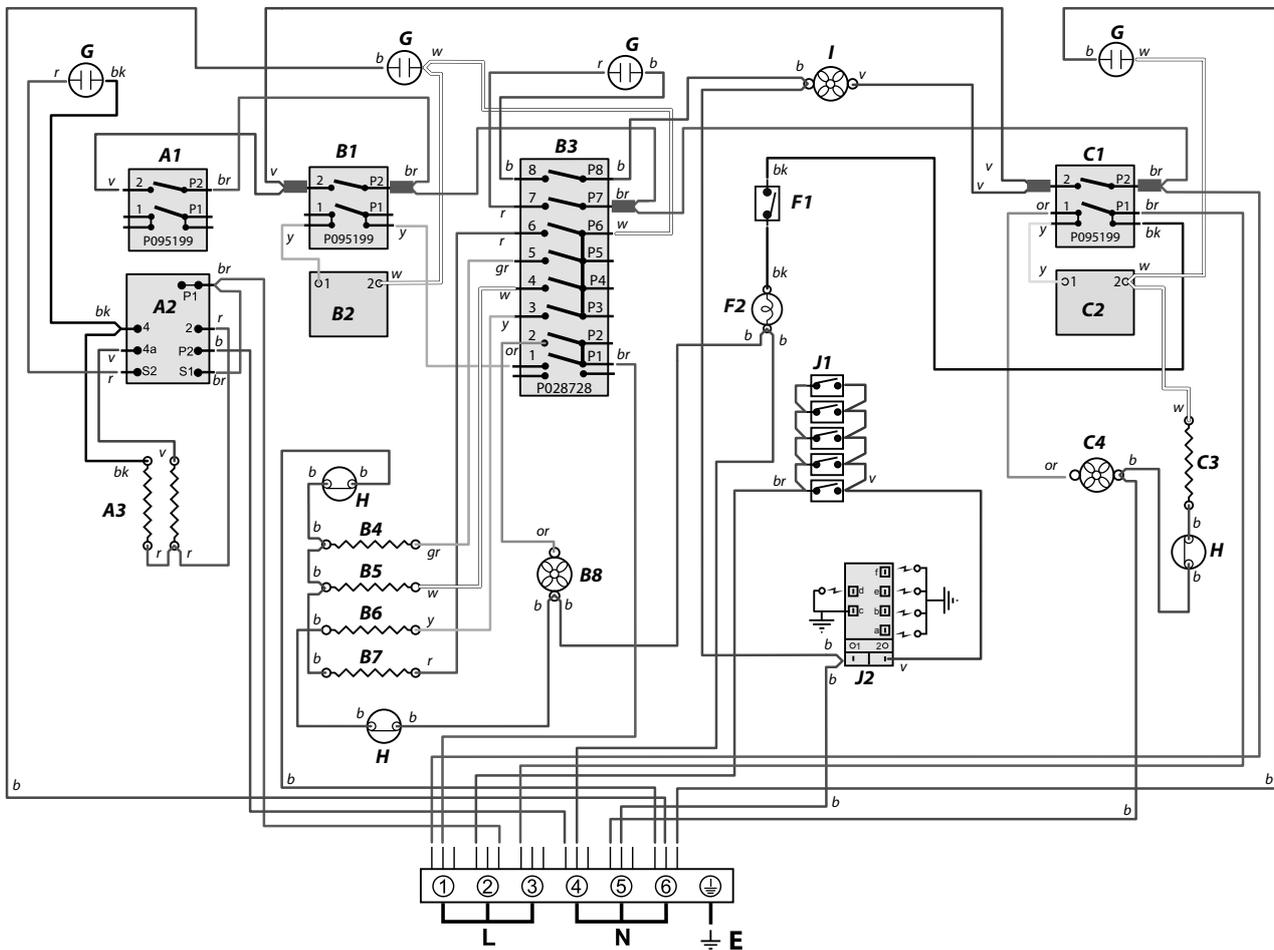
Le raccord indiqué sur le schéma de câblage est pour une alimentation monophasée. Les capacités nominales sont pour 230 V 50 Hz.
