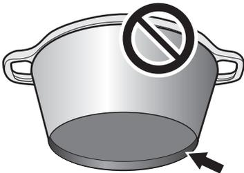
L'utilisation de dispositifs de mijotage, de type plaques d'amiante ou plaques métalliques, est **DECONSEILLÉE** (**Fig.2.6**). Ces dispositifs diminueront les performances de la cuisinière et risquent d'endommager les grilles de la table de cuisson.
