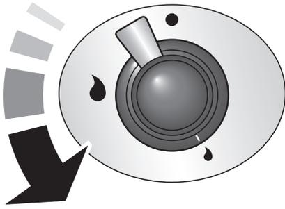
Si le brûleur s'éteint lorsque vous relâchez le bouton de commande, le dispositif de sécurité n'a pas été enclenché. Mettez le bouton de commande sur la position Arrêt [Off] et attendez une minute avant d'essayer de nouveau, en appuyant un peu plus longtemps sur le bouton.
