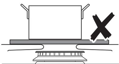
Le diamètre minimum recommandé pour les récipients de cuisson est de 160 mm. Le diamètre maximum pour les récipients de cuisson est de 260 mm.
