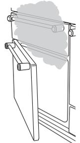
La cuisson d'aliments à haute teneur en eau peut produire une « bouffée de vapeur » à l'ouverture de la porte du four. Lorsque vous ouvrez la porte du four, reculez-vous et attendez que la vapeur se soit dissipée. Veillez à prévenir toute infiltration d'eau dans l'appareil.
