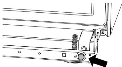
Drehen Sie zum Einstellen der Vorderfüße die Unterteile, um sie zu heben oder zu senken.
