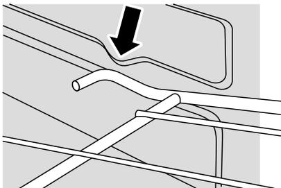
Om een rek in de oven te schuiven, kiest u een inschuifrichel en duwt u tegen het rek tot de achterkant van het rek tegen de achteraanslag aan zit. Til de voorkant van het rek op om de achterkant van het rek onder de achteraanslagen door te halen. Duw het rek vervolgens helemaal in de oven.
