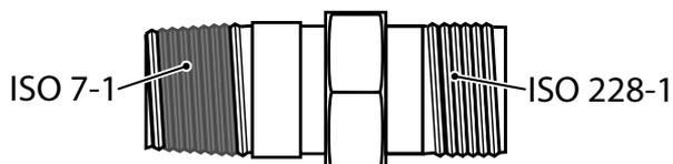
Vissez le raccord sur l'admission de la cuisinière, en serrant uniquement à la main. Placez deux outils appropriés - un sur l'admission pour prévenir tout mouvement et un autre sur le raccord - et serrez le raccord sur l'admission de la cuisinière.
