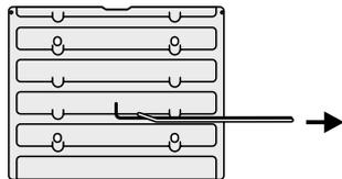
Soulevez la partie avant de la grille pour faire passer l'arrière de la grille sous la butée d'arrêt, puis tirez la grille vers l'avant.
