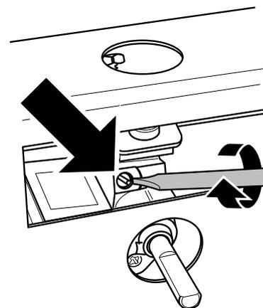
Die Bypass-Schraube an jeder Steuerung im Uhrzeigersinn drehen, bis sie stoppt.
