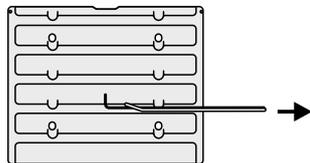
Die Vorderseite des Rostes anheben, so dass die Rückseite des Rostes unter dem Schiebeleistenanschlag hindurchgeht und dann den Rost nach vorne ziehen.
