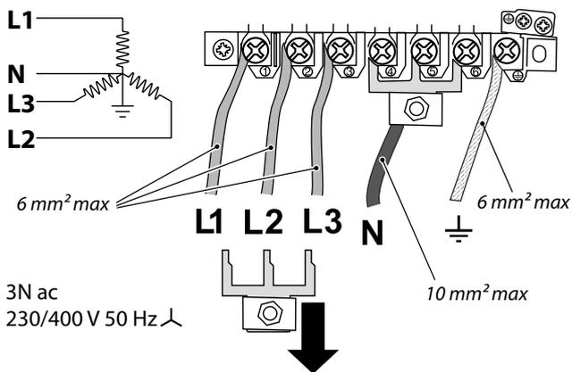
Kontrollieren, ob die Verbindungen korrekt angebracht und die Klemmschrauben fest angezogen sind. Das Netzkabel über die Kabelschelle befestigen.
