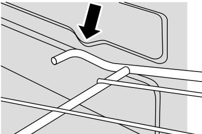
Pour remettre la grille en place, mettez la grille à niveau avec une glissière latérale du four, puis insérez la grille à fond jusqu'à ce que les extrémités soient en contact avec la butée d'arrêt de la grille. Soulevez l'avant de la grille pour que les
