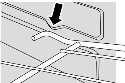
Um den Rost wieder einzusetzen, den Rost mit einer Rille in der Ofenseite ausrichten und den Rost nach hinten schieben, bis das Ende an den Schiebeleistenanschlag stößt. Den vorderen Teil anheben, so dass die Rostenden über die Schiebeleistenanschlüsse gehen und dann den vorderen Teil absenken, so dass der Rost waagrecht ist und ihn ganz nach hinten schieben.
