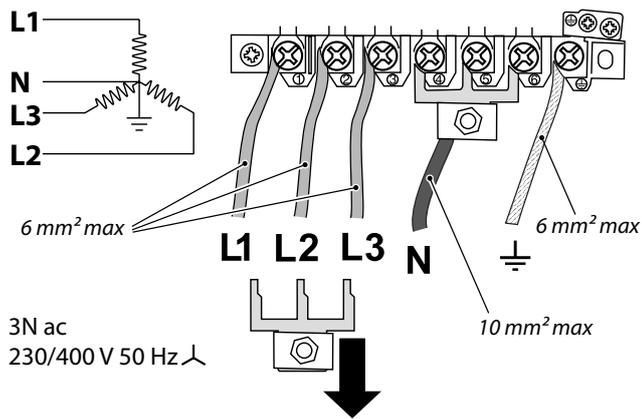
Vérifiez que les connecteurs sont montés correctement et que les vis des bornes sont bien serrées. Fixez le câble d'alimentation secteur à l'aide du serre-câble.
