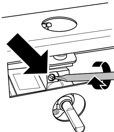
Draai de bypass-schroef op iedere controle met de wijzers van de klok mee totdat hij stopt.
