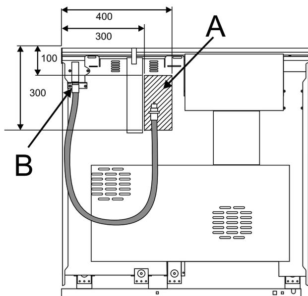
Die hinteren Abdeckkästen beschränken die Position des Versorgungsanschlusses. Die Hausgasversorgung muss mit einem nach unten gerichteten Anschluss abgeschlossen werden.
