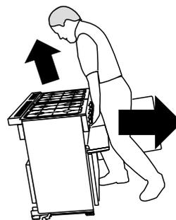
Déplacez la cuisinière progressivement, en vérifiant à l'arrière que le tuyau de gaz n'est pas entravé. Vérifiez que le tuyau de gaz et le câble électrique sont assez longs pour permettre le déplacement de la cuisinière vers l'avant.
