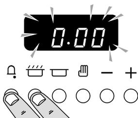
Die Knöpfe wie gezeigt drücken und gedrückt halten. Gleichzeitig (-) oder (+) drücken, bis die korrekte Zeit zu sehen ist. Vergessen Sie nicht, dass es eine 24-Stunden-Uhr ist. Wenn Sie einen Fehler machen oder die falsche Taste drücken, die Stromversorgung eine oder zwei Minuten lang ausschalten und den Vorgang wiederholen.
