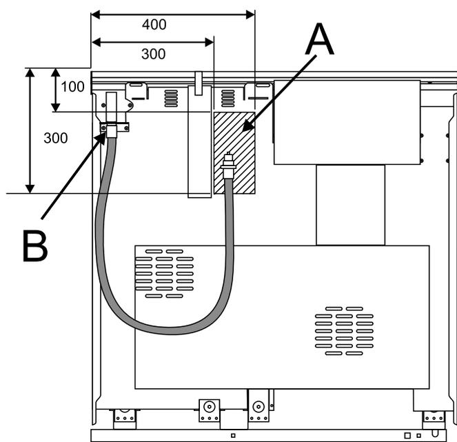
Les boîtiers arrière de la cuisinière limitent la position du point d'alimentation. L'alimentation en gaz domestique doit être terminée par un raccord orienté vers le bas.
