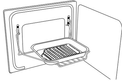
Het 'Handyrack' past uitsluitend op de deur van de linkeroven. Het 'Handyrack' heeft een maximumcapaciteit van 5,5 kg. Het 'Handyrack' dient uitsluitend te worden gebruikt in combinatie met de bijgeleverde vleespan die op het 'Handyrack' past. Andere blikken zijn wellicht onstabiel.
