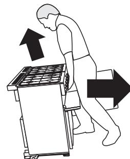
Den Herd immer nur ein Stück bewegen und hinter dem Herd kontrollieren, dass sich der Gasschlauch nicht verfangen hat. Sicherstellen, dass das Stromkabel und der Gasschlauch lang genug sind, um den Herd nach vorne zu bewegen.
