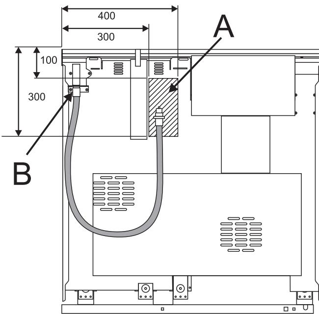
Les boîtiers arrière de la cuisinière limitent la position du point d'alimentation. L'alimentation en gaz domestique doit être terminée par un raccord orienté vers le bas.
