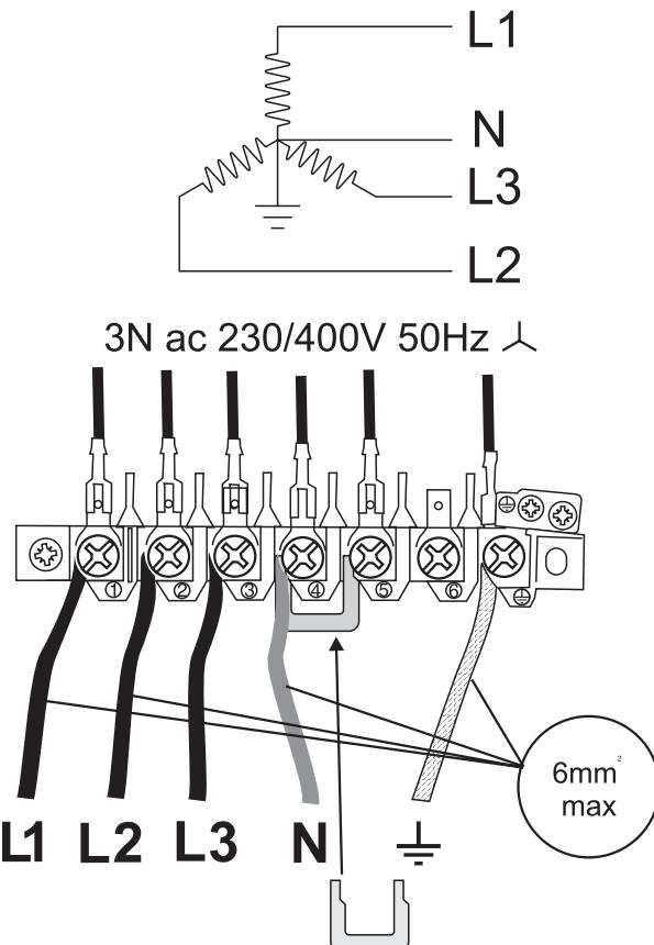
Kontrollieren, ob die Verbindungen korrekt angebracht und die Klemmschrauben fest angezogen sind. Das Netz-
