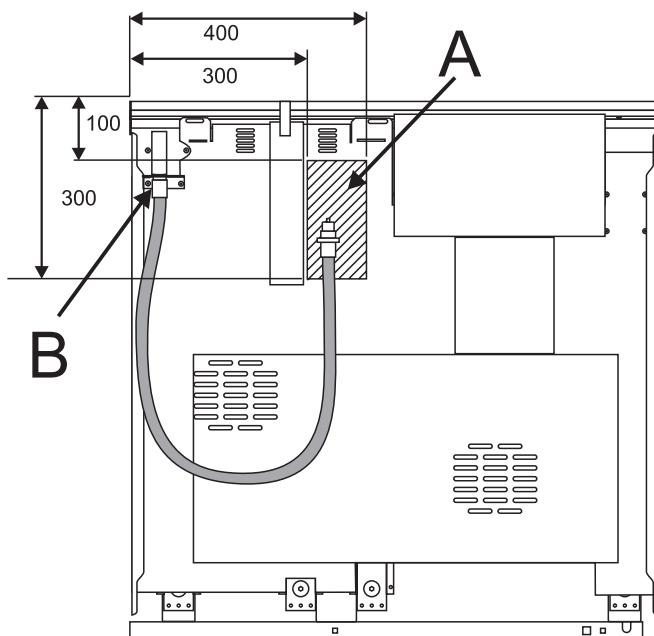
De afschermkasten aan de achterkant beperken de positie van het toevoerpunt. De eindaansluiting van de huishoudelijke gasvoeding dient naar beneden te zijn gericht.
