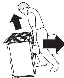
Verplaats de oven stukje bij stukje en controleer telkens of de gasslang niet is blijven haken. Zorg tijdens het verplaatsen van het fornuis telkens dat de stroomkabel en de gasleiding voldoende speling hebben.
