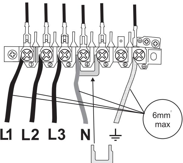
Vérifiez que les connecteurs sont montés correctement et que les vis des bornes sont bien serrées. Fixez le câble d'alimentation secteur à l'aide du serre-câble.
