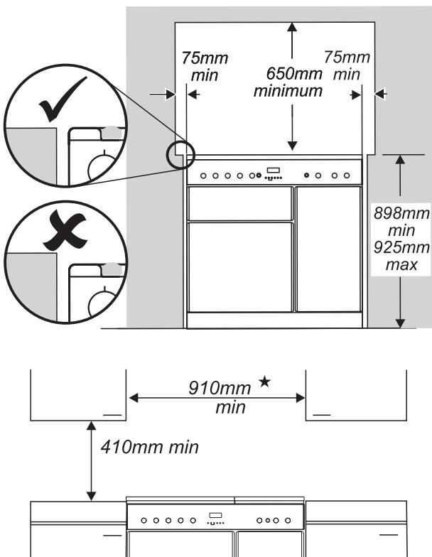
De rand van de kookplaat dient op gelijke hoogte of boven eventuele naastgelegen werkbladen te zitten. Boven het niveau van de kookplaat dient tussen de zijkanten van het fornuis en eventuele naastgelegen verticale oppervlakken een tussenruimte van ten minste 75 mm te worden gelaten.
