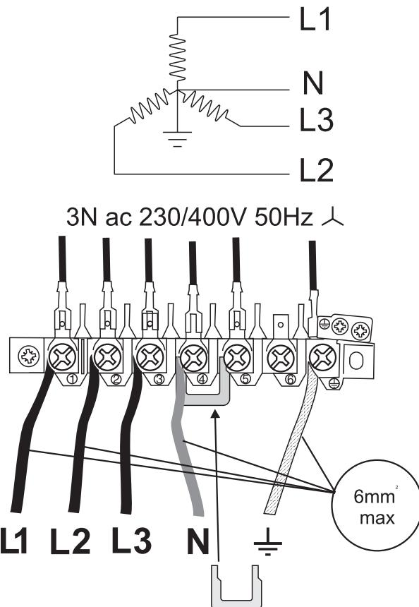
Controleer of de aansluitingen goed vastzitten en of de schroeven van de aansluitpunten goed vastzitten. Zet de elektriciteitskabel vast met de kabelklem.
