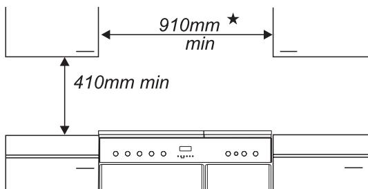
Le pourtour de la table de cuisson doit être au niveau, ou au-dessus de tout plan de travail adjacent. Au-dessus du niveau de la table de cuisson, laissez un espace de 75 mm entre chaque côté de la cuisinière et toute surface verticale adjacente.
