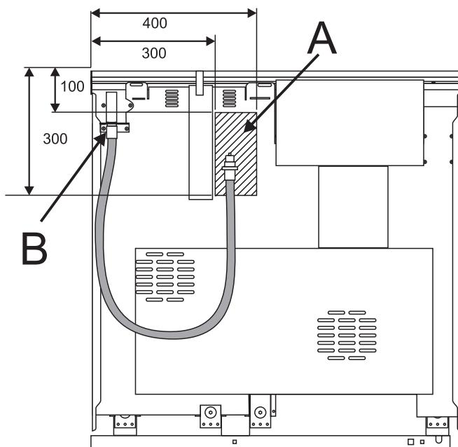
Die hinteren Abdeckkästen beschränken die Position des Versorgungsanschlusses. Die Hausgasversorgung muss mit einem nach unten gerichteten Anschluss abgeschlossen werden.
