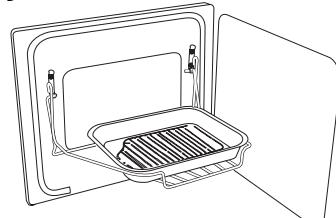
Het 'Handyrack' past uitsluitend op de deur van de linkeroven. Het 'Handyrack' heeft een maximumcapaciteit van 5,5 kg. Het 'Handyrack' dient uitsluitend te worden gebruikt in combinatie met de bijgeleverde vleespan die op het 'Handyrack' past. Andere blikken zijn wellicht onstabiel.
