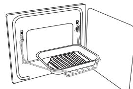
Le Handyrack se monte uniquement sur la porte du four gauche. Le poids maximum supportable par le Handyrack est de 5,5 kg. Il ne doit être utilisé qu'avec le plat à viande fourni, qui est spécialement conçu pour être utilisé avec le Handyrack. Tout autre récipient de cuisson risque d'être instable.
