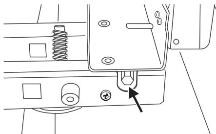
Stel de hoogte van het voorste wieltje af om het fornuis waterpas te stellen. Draai hem met de klok mee om het fornuis omhoog te brengen of tegen de klok in om het fornuis te laten zakken.
