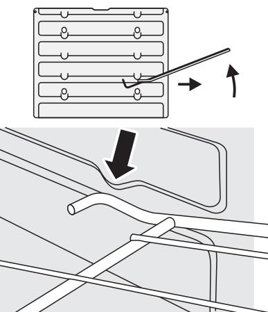
Om een rek in de oven te schuiven, kiest u een inschuifrichel en duwt u tegen het rek tot de achterkant van het rek tegen de achteraanslag aan zit. Til de voorkant van het rek op om de achterkant van het rek onder de achteraanslagen door te halen. Duw het rek vervolgens helemaal in de oven.
