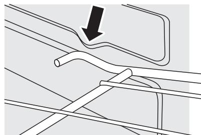
Um den Rost wieder einzusetzen, den Rost mit einer Rille in der Ofenseite ausrichten und den Rost nach hinten schieben, bis das Ende an den Schiebeleistenanschlag stößt. Den vorderen Teil anheben, so dass die Rostenden über die Schiebeleistenanschläge gehen und dann den vorderen Teil absenken, so dass der Rost waagerecht ist und ihn ganz nach hinten schieben.
