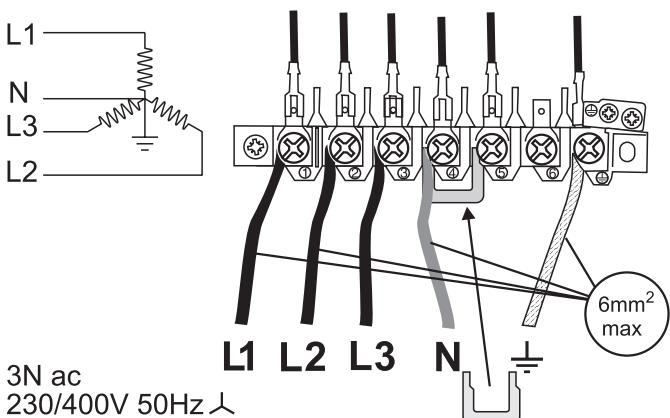
Controleer of de aansluitingen goed vastzitten en of de schroeven van de aansluitpunten goed vastzitten. Zet de elektriciteitskabel vast met de kabelklem.
