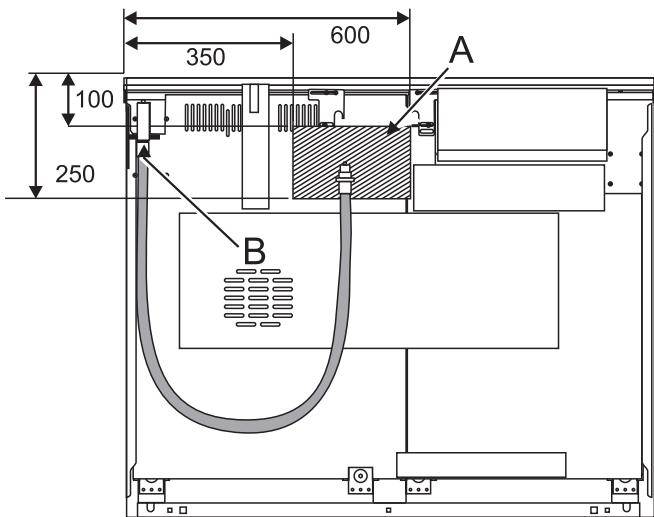
Die hinteren Abdeckkästen beschränken die Position des Versorgungsanschlusses. Die Hausgasversorgung muss mit einem nach unten gerichteten Anschluss abgeschlossen werden.
