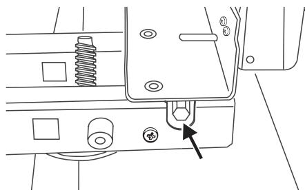
Die Höhe der vorderen Rolle einstellen, um den Herd waagerecht zu stellen. Im Uhrzeigersinn drehen, um den Herd anzuheben, gegen den Uhrzeigersinn, um ihn zu senken.
