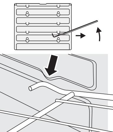
Pour remettre la grille en place, mettez la grille à niveau avec une glissière latérale du four, puis insérez la grille à fond jusqu'à ce que les extrémités soient en contact avec la butée d'arrêt de la grille. Soulevez l'avant de la grille pour que les extrémités puissent dépasser les butées, puis abaissez l'avant pour mettre la grille à l'horizontale, avant de l'insérer à fond.
