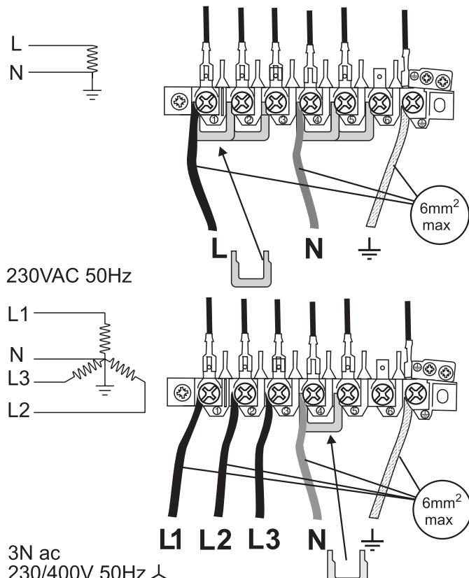
Kontrollieren, ob die Verbindungen korrekt angebracht und die Klemmschrauben fest angezogen sind. Das Netzkabel über die Kabelschelle befestigen.
