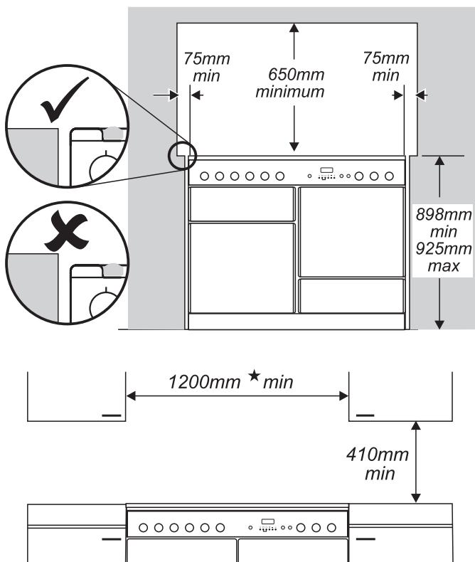
Le pourtour de la table de cuisson doit être au niveau, ou au-dessus de tout plan de travail adjacent. Au-dessus du niveau de la table de cuisson, laissez un espace de 75 mm entre chaque côté de la cuisinière et toute surface verticale adjacente.
