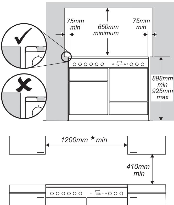
De rand van de kookplaat dient op gelijke hoogte of boven eventuele naastgelegen werkbladen te zitten. Boven het niveau van de kookplaat dient tussen de zijkanten van het fornuis en eventuele naastgelegen verticale oppervlakken een tussenruimte van ten minste 75 mm te worden gelaten.
