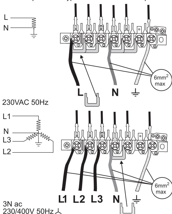
Vérifiez que les connecteurs sont montés correctement et que les vis des bornes sont bien serrées. Fixez le câble d'alimentation secteur à l'aide du serre-câble.
