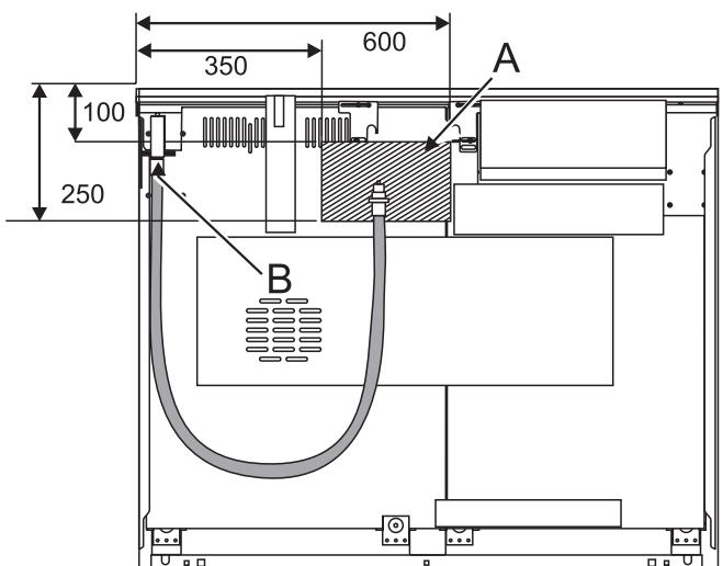
De afschermkasten aan de achterkant beperken de positie van het toevoerpunt. De eindaansluiting van de huis-houdelijke gasvoeding dient naar beneden te zijn gericht.
