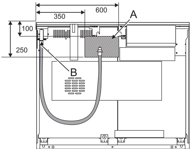
Les boîtiers arrière de la cuisinière limitent la position du point d'alimentation. L'alimentation en gaz domestique doit être terminée par un raccord orienté vers le bas.
