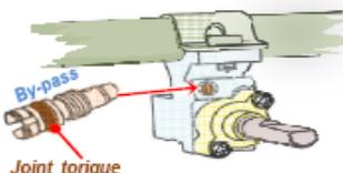
Les BY PASS ou VIS DE RALENTI équipent chaque robinet et sont calibrés suivant la puissance du brûleur. Lors du contrôle de tenue de flamme, le réglage du ralenti peut être ajusté en modifiant le serrage du by pass.
