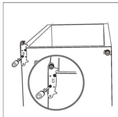
7. Remettez la porte supérieure en place. Assurez-vous que la porte est alignée horizontalement et verticalement afin que les joints soient fermés de tous les côtés avant de finalement serrer la charnière supérieure.
