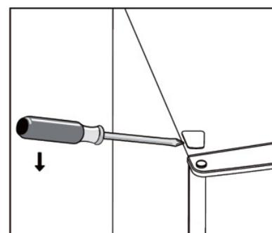
4. Déplacez le couvercle du noyau du côté gauche au côté droit. Puis soulevez la porte supérieure et placez-la sur une surface rembourrée pour éviter qu'elle ne se raye.
