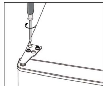
8. Insérez le support de charnière et vissez-le sur le dessus de l'appareil.
