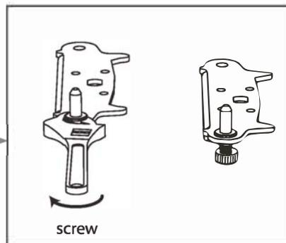
6. Réajustez le support en ajustant l'axe de la charnière inférieure. Remplacez les deux pieds réglables.
