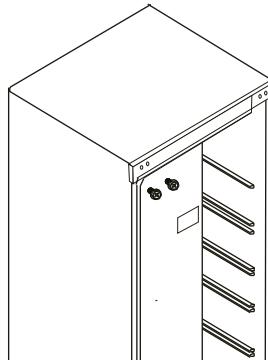
4. Posez délicatement l'arrière de l'appareil sur une surface matelassée. Retirez d'abord deux pieds de mise à niveau. Puis dévissez la charnière de la porte et la base du pied gauche.
