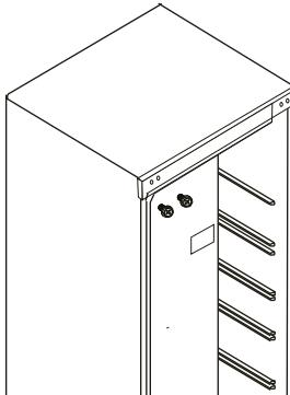
4. Con cuidado, tumbe la parte trasera del aparato sobre una manta suave. Retire las dos patas niveladoras primero. Después desatornille la bisagra de la puerta y la base de la pata izquierda.
