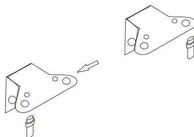
8. Mettez l'appareil debout et placez la porte sur la charnière du bas. Assurez-vous que le centre de la charnière du bas est inséré dans le trou de la porte. Puis installez la charnière du haut avec la porte. Avant de fixer complètement la charnière du haut, essayez d'ouvrir la porte pour vérifier que l'appareil se ferme correctement. Enfin, vissez le cache charnière avec la charnière.
