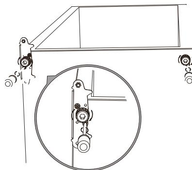
7. Desatornille la bisagra superior y móntela en el orificio izquierdo.
