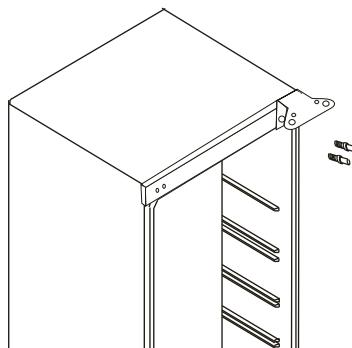
3. Retire la tapa y tornillos del lado izquierdo y fíjelos en el lado derecho.
