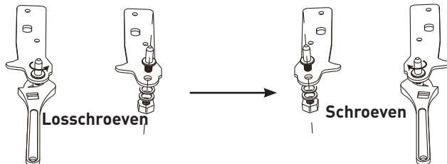
6. Plaats de scharnier aan de linkerkant en de onderkant van de voet aan de rechterkant. Schroef de twee verstelbare voetjes vast met hun originele onderdelen.
