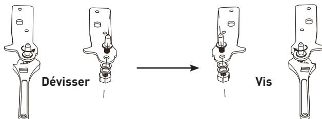
6. Installez la charnière à gauche et la base du pied à droite. Puis vissez les deux pieds de mise à niveau avec leurs pièces d'origine.
