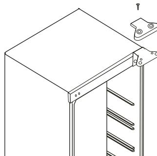
2. Ouvrez la porte et dévissez la charnière du haut. Puis retirez la porte de l'appareil et placez-la sur une surface rembourrée pour éviter de l'endommager.
