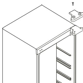
2. Open de deur en schroef de bovenste scharnier los. Haal de deur van de kast en plaats ze op een zachte ondergrond om schade te vermijden.
