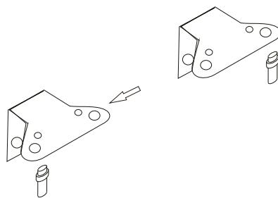
8. Zet het toestel recht en plaats de deur op de onderste scharnier. Zorg ervoor dat de scharnier goed in de deurholte zit. Plaats dan de deur op de bovenste scharnier. Probeer de deur te openen om te zien of het toestel goed sluit voor u de bovenste scharnier goed vastdraait. Schroef het scharnierdeksel op de scharnier.
