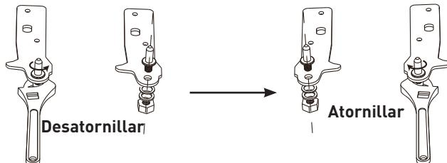
6. Instale la bisagra en el lado izquierdo y la base de la pata en el lado derecho. Después atornille las dos patas de nivelación a sus partes originales.
