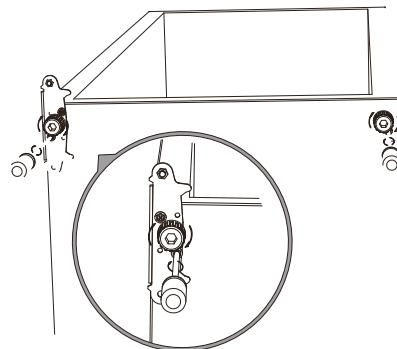
7. Schroef de bovenste scharnierpen los en montere ze op het linkse gat.
