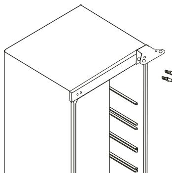
3. Retirez le cache et les vis du côté gauche et installez-les du côté droit.
