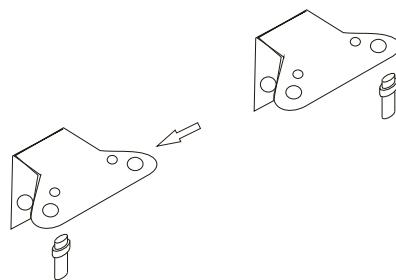
8. Levante la unidad y coloque la puerta en la bisagra inferior. Asegúrese de que el centro de la bisagra inferior queda insertado en el orificio de la puerta. A continuación, fije la bisagra superior a la puerta. Antes de fijar firmemente la bisagra superior, intente abrir la puerta para comprobar si el aparato queda bien sellado. Finalmente, atornille la tapa de la bisagra a la bisagra.
